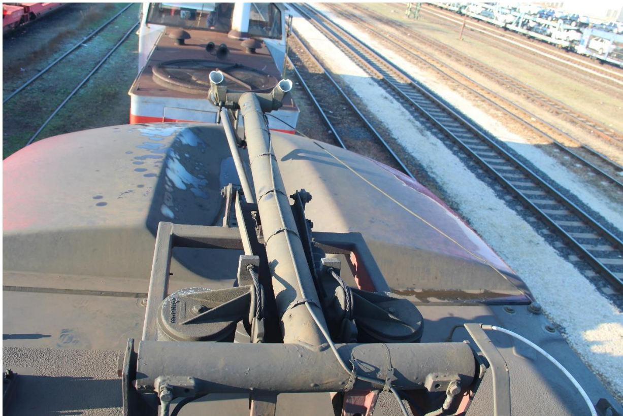
2. kép: Hegyeshalom állomáson az úrszelvénybe lógó felsővezetési elem okozta áramszedősérülés, 2024.12.27.
