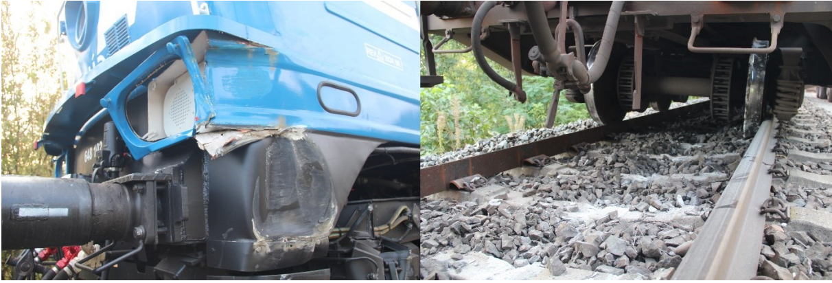
3. kép: Vonat ütközése úrszelvényben lévő akadállyal Soroksári út és Soroksár állomások között a 63. szelvényben 2024.09.24. (A 41137-2 sz. vonat egy úrszelvénybe befordult munkagéppel ütközött. A mozdony és az első 7 db kocsit kisiklott, a kisiklott járművek és a pálya kb. 160 m hosszban megrongálódtak).
